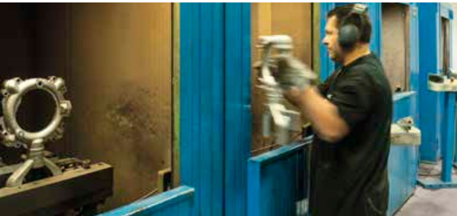
REPARTO STERRATURA CON SISTEMI VIBRANTI AD ALTA FREQUENZA
